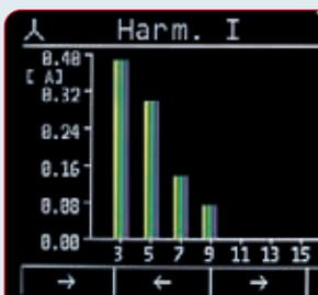
Balkendiagramm zur grafischen Darstellung der Oberschwingungen bis zur 63. Spannungs- und Stromharmonischen
