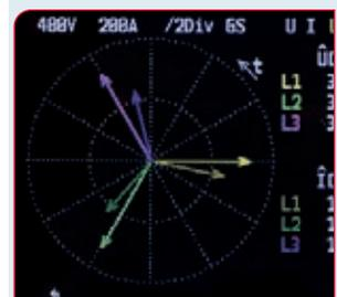
Zeigerdiagramm von Spannung und Strom zur Analyse des Phasenwinkels
