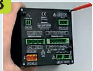
Neue Geräterückwand mit den vier Kreuzschlitzschrauben befestigen – fertig.
