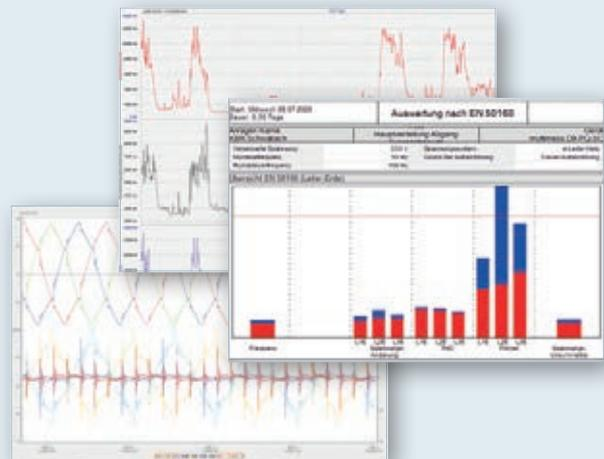
Im Einsatz als Power Quality Interface ermöglicht **multimes F144-PQ** umfassende Auswertungen nach Netzqualitätsnorm DIN-EN-50160
