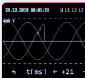
Grafische Diagnose des Spannungs- und Stromverlaufes bei Netzeinbruch nach EN 61000-4-30
