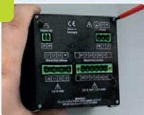
Wandler kurzschließen und Anschlussstecker abziehen. Die vier Kreuzschlitzschrauben entfernen und Geräterückwand abnehmen.
